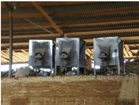
De biomassa wordt verwerkt in de machines en wordt gebruikt als brandstof voor de oven die de keramische stenen en dakpannen droogt
