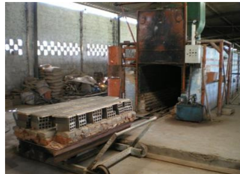
De biomassa wordt verwerkt in de machines en wordt gebruikt als brandstof voor de oven die de keramische stenen en dakpannen droogt
